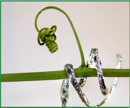
Pehme robot suudab keerduda ümber Passiflora caerulea varre
