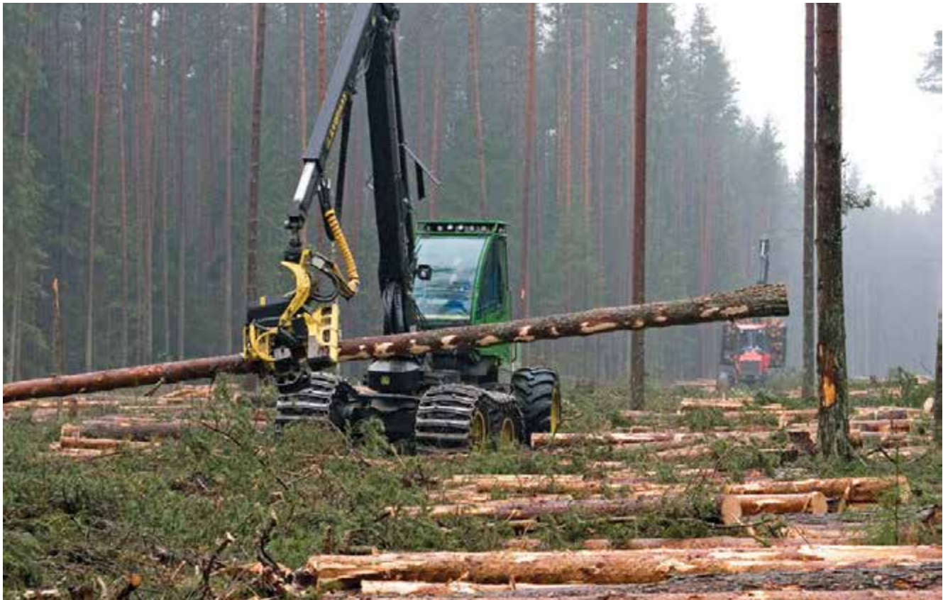
Lageraie Viru-Tammiku metsandikus John Deerega 2008. aastal. Harvesteri jälgedes sõidab forvarder, mil on tegelikult oht metsaalust rohkem lõhkuda kui langetustraktoril.
