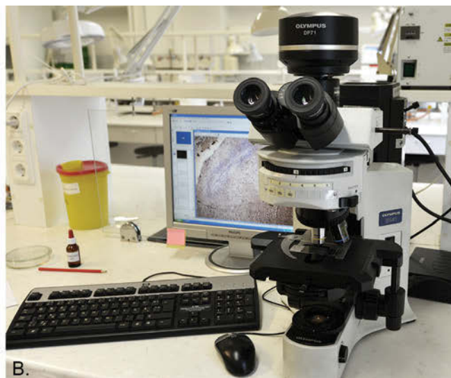
◇ 4. Nüüdisaegne fluorestsentsmikroskoop. A – skeemil on näidatud nähtava valguse teekond (alumine valgusallikas) ja fluo- restsentsvalguse teekond (ülemine valgusallikas) läbi objektiivi objektini ja registreeriva okulaarini. B – fluorestsentsvõimeku- sega uurimismikroskoop Olympus BX41 (Jaapan), arvutikuva inimese emaka endomeetriumi (kasutatud programmi CellB, Soft Imaging System, Olympus)
