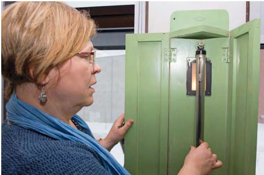
Elavhõbedabaromeetrilt on selgelt näha, kust tuleb normaalrõhk 760 mm Hg, mida iga koolilapski teab: see ongi keskmiselt elavhõbedasamba kõrgus. Praegusaegsetelt instrumentidelt sellised otseseid füüsikalisi seoseid ei näe
