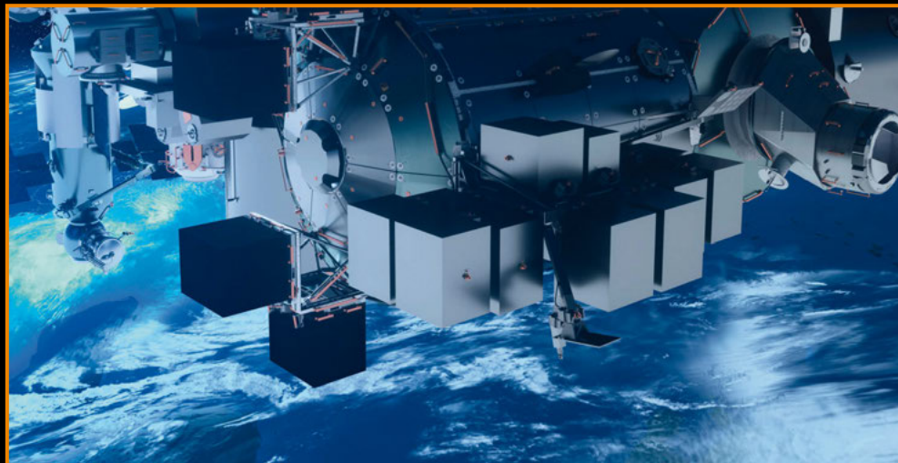
ISS-i Columbase mooduli külge kinnitatud Bartolomeo platvormi (hallidest kuubikutest koosnev detail) ideekavand
