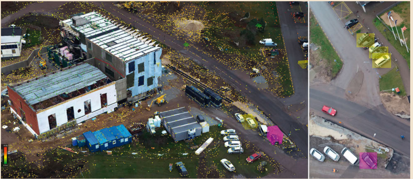
Vasakpoolsel fotogramm-meetriaga saadud ehitusobjekti kolmemõõtmelisel mudelil on näha pildianalüüsiga (mida näitab parempoolne pilt) leitud ruumilised kuubikud (kollane ja roosa kuubik sõidukite ümber). Taoliste objektide äratundmiseks saab kasutada kas standardseid detektoreid või siis treenides selleks ise masinõppealgoritme. Näidatud pildianalüüsil kasutati tarkvara Bentley ContextCapture Insight
