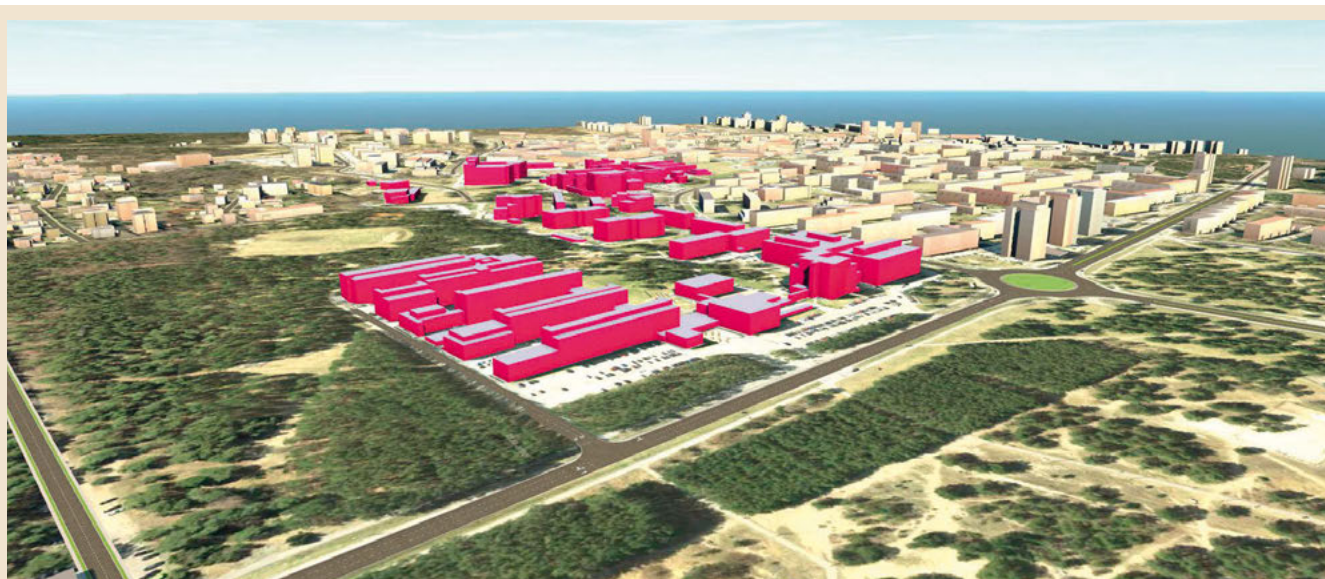
Sel Tallinna tehnikaülikooli linnaku (punased hooned) ümbruse ruumilisel kujutisel on maapind loodud maa-ameti laserkiiretehnikaseadmega LiDAR möödistatud kõrguspunktide alusel. Nende kõrgusandmete abil saab teha planeeringute esmaseid ruumilisi analüüse, arvestades seejuures ka hoonete ligikaudseid mahtusid. Modelleerimisel kasutati tarkvara Autodesk InfraWorks
