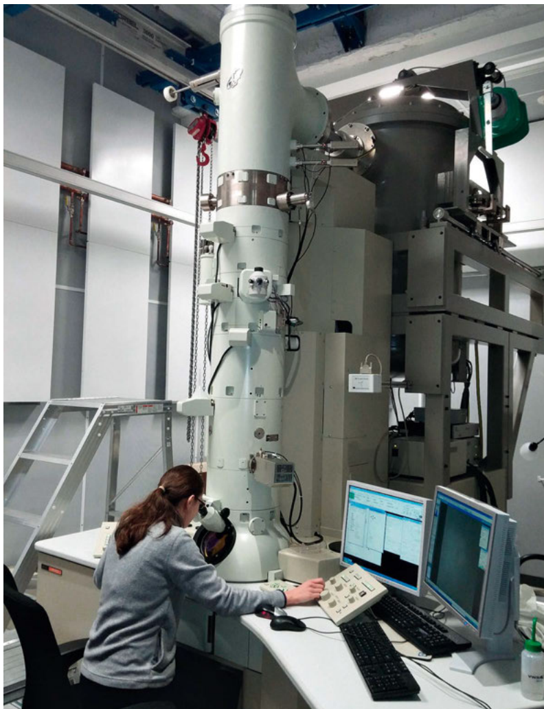
Pildil on Northwesterni ülikooli krüoelektronmikroskoop
