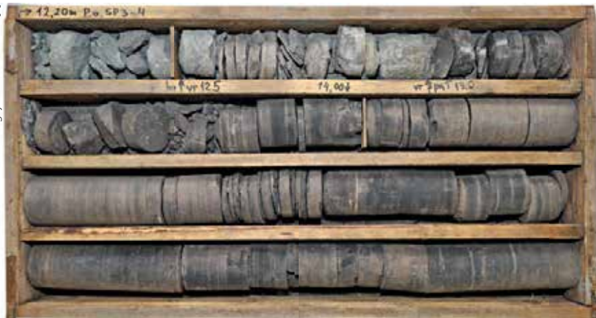
◇ 3. Eesti must kilt – graptoliitargilliit – puursüdamikus. Juba ammu on teada, et siinne graptoliitargilliit sisaldab võrdlemisi palju mitut olulist metalli, sh uraani, vanaadiumi, tsinki ja molübdeeni
