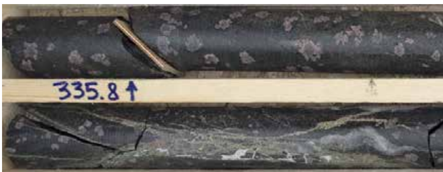
◇ 4. Jõhvi alal puuritud kivimiproov magnetiiti sisaldavast gneisist. Punakad kogumid on mineraal granaat. Kivimisse on lõikunud kloriiti ja kaltsiiti sisaldavad lõhed
